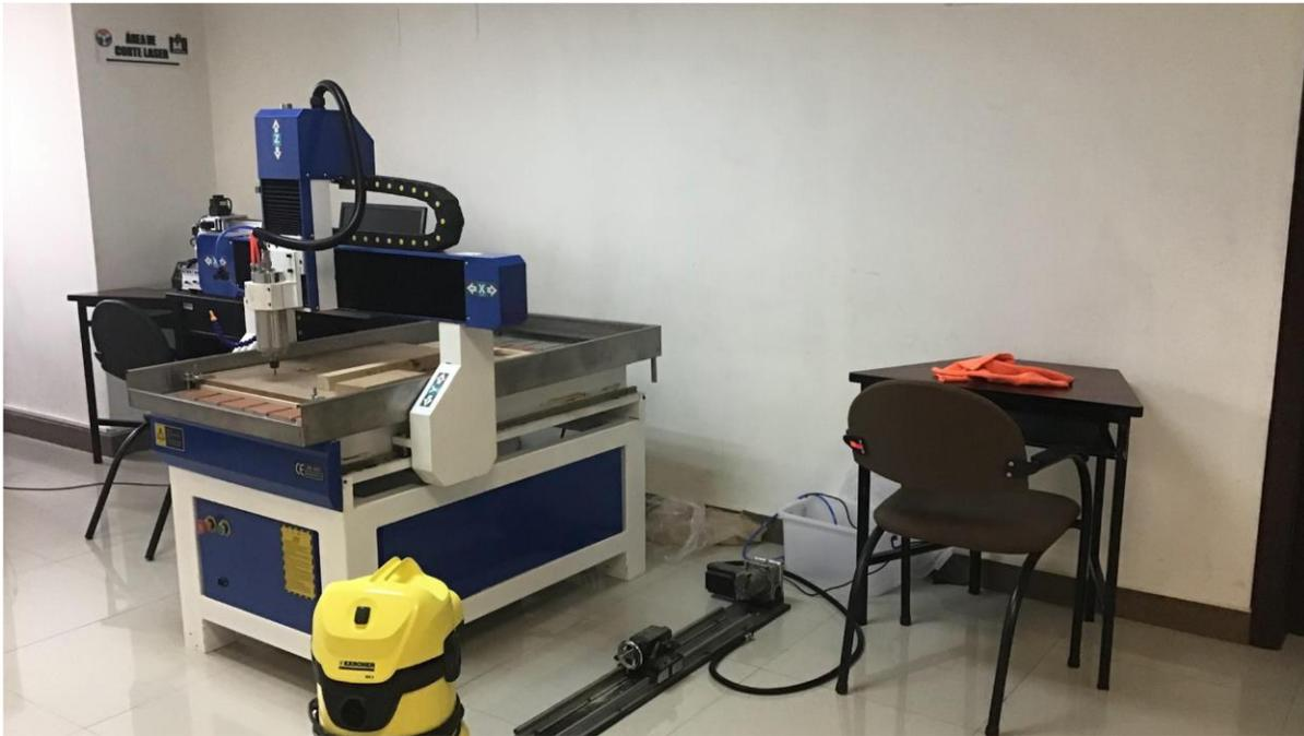
Se observa una fresadora de formato medio con un eje rotativo parcialmente funcional pero sin un sistema de extracción óptimo (se debe mejorar).
