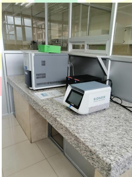
Foto 3: Espectrofotómetro de micro-volumenes para DNA, RNA y proteínas:
